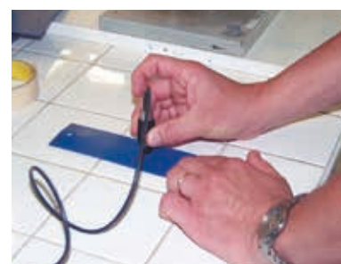
Contrôle de l'épaisseur du thermolaquage
